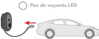
**2-** Placez le câble de recharge sur le support de prise de la station.
