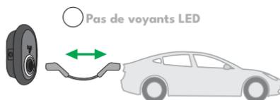
**3-** Branchez le câble de recharge à la prise du véhicule et à la prise de la station de recharge ; le voyant d'état LED devient vert.
