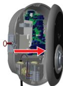
3- Modifiez la position du 1er commutateur DIP à l'aide d'un poinçon pointu ou d'un outil pointu en plastique. La position du commutateur DIP est indiquée dans la figure ci-dessous.
